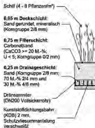
RBF Detail Filteraufbau M 1:50)
