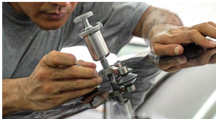
Kleine Schäden in der Frontscheibe lassen sich reparieren, sofern sie sich nicht im Sichtfeld des Fahrers befinden und eine bestimmte Größe nicht überschreiten.
