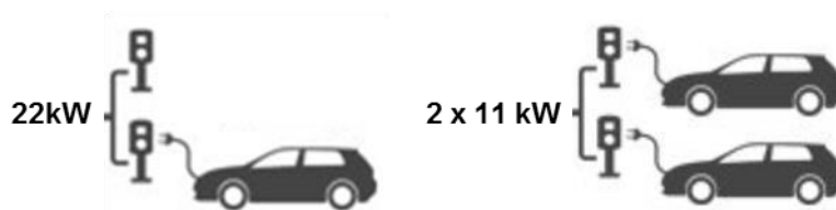
Abbildung 7-4: Schema integriertes Lastmanagement
